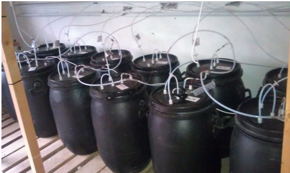
Figur 1. Foto af det dynamiske emissionskammersystem bestående af ti lukkede plasttønder, som hver blev tilført 42 l frisk homogeniseret økologiske kvæggylle. Hvert af de enkelte kamre blev ventileret med 1,8 l luft per minut.
